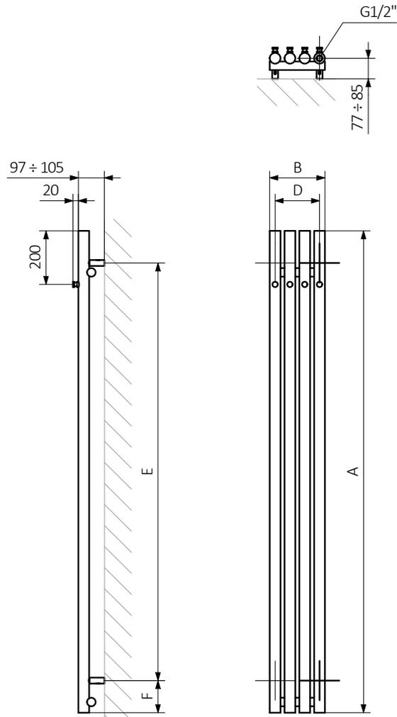
A – Hauteur B – Largeur C1-C5 – espacement des connexions D – espacement horizontal des attaches
