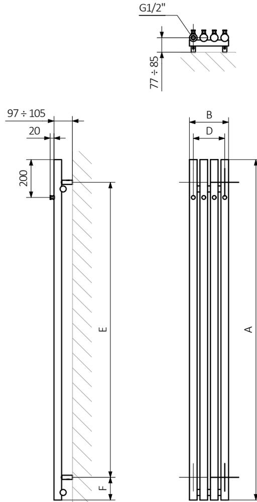
A – Hauteur B – Largeur C1-C5 – espacement des connexions D – espacement horizontal des attaches E – espacement vertical des attaches F – distance de l'axe inférieur des attaches au bord inférieur du collecteur
