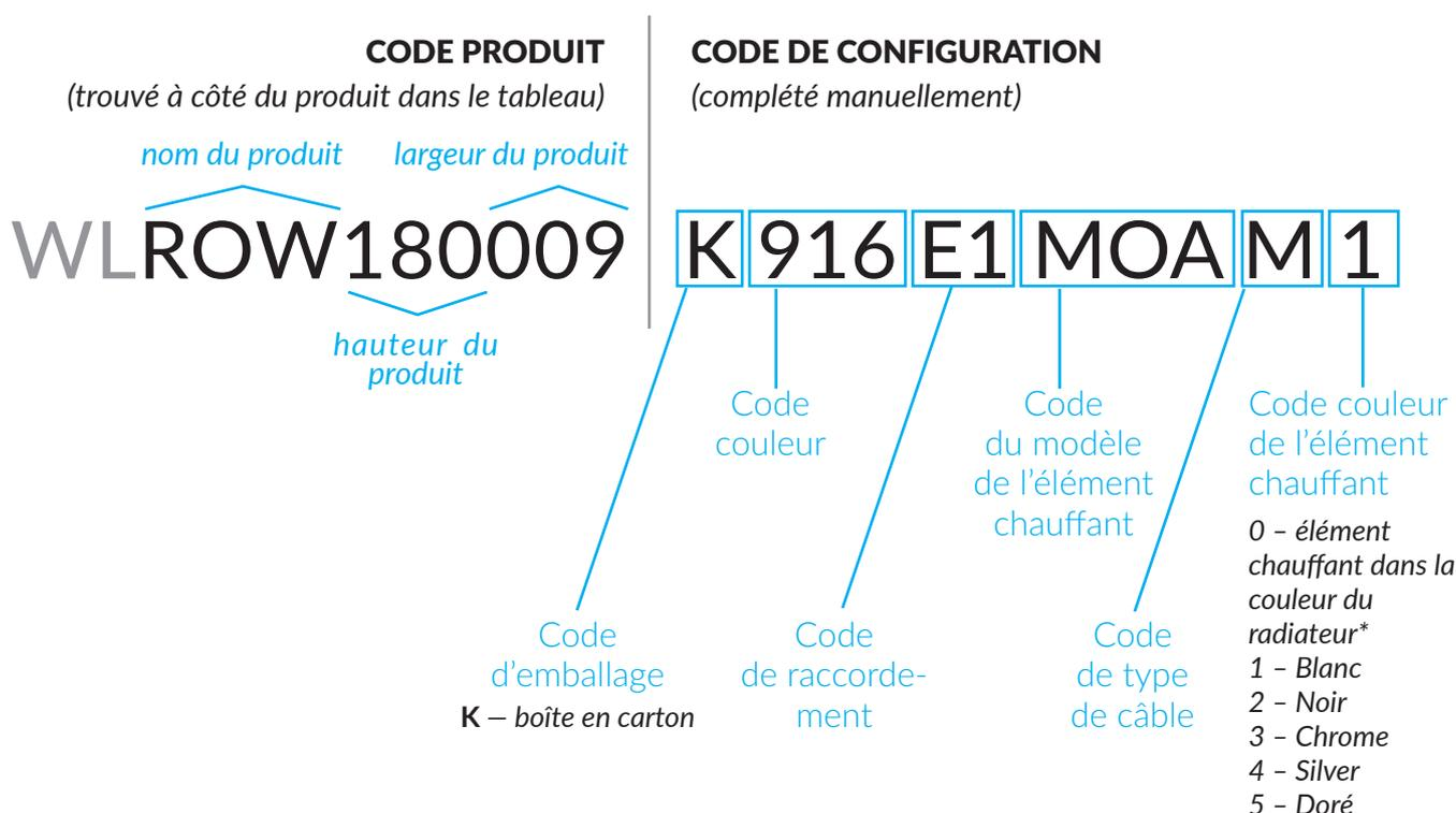
WL – sèche-serviettes électrique ou radiateur rempli d'huile et équipé d'un élément chauffant installé en usine
